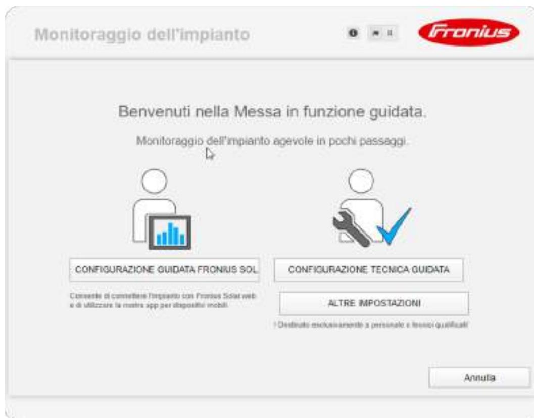
"Configurazione tecnica guidata" è prevista per gli installatori e contiene impostazioni specifiche relative alle norme. **L'esecuzione di "Configurazione tecnica guidata" è opzionale.**
