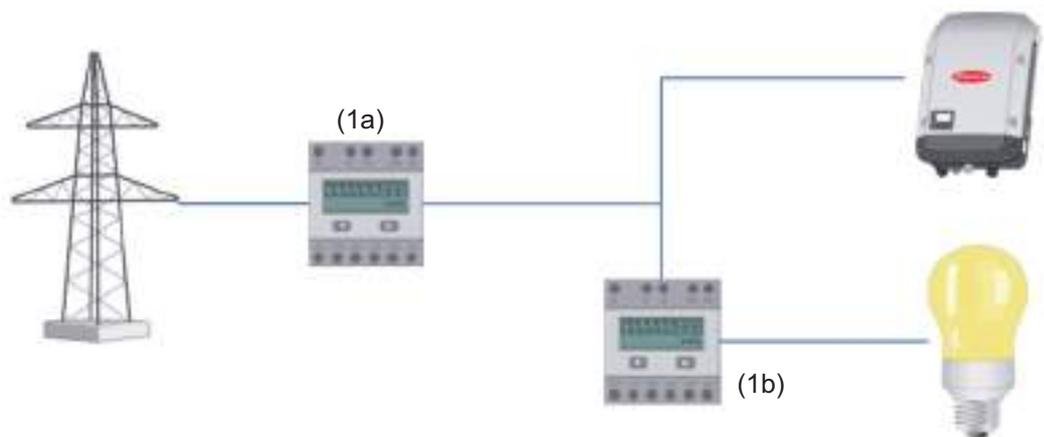
È possibile collegare direttamente all'inverter un contatore per il rilevamento dell'autoconsumo per ogni S0.
