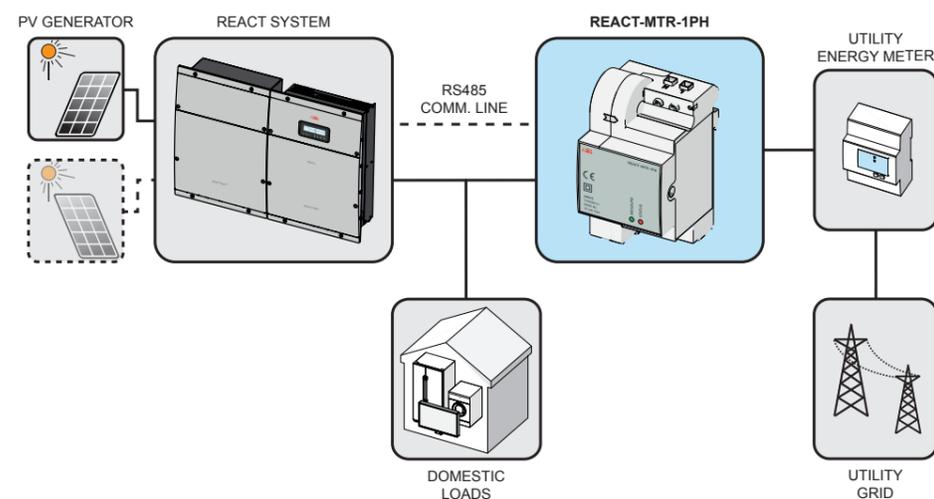
Il REACT-MTR-1PH dispone di due LED multicolore, "Status" e "Measure", che indicano in tempo reale lo stato del dispositivo e la direzione del flusso di energia (importazione / esportazione dell'energia).
