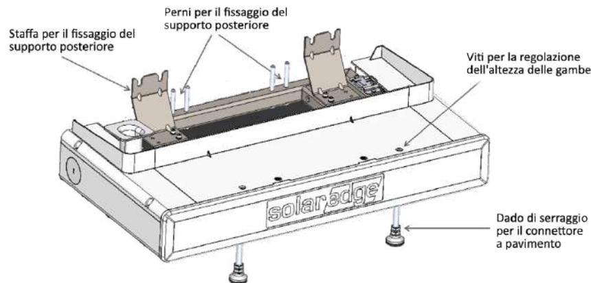
Figura 2: Base di montaggio e punti di fissaggio
