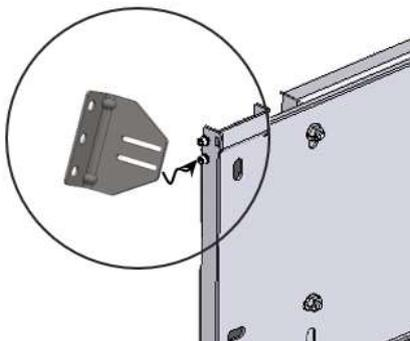
10. Usare i fori nella staffa a muro per segnare la posizione sul muro per tre fori di fissaggio su ogni lato. Spostare il supporto da pavimento per consentire di praticare i fori. Praticare i fori, riposizionare il supporto da pavimento e fissare le staffe a muro alla parete.
