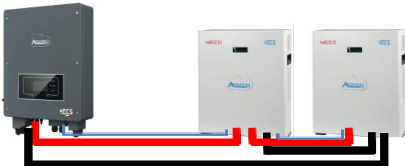
Figura - esempio di collegamenti con n°2 batterie
