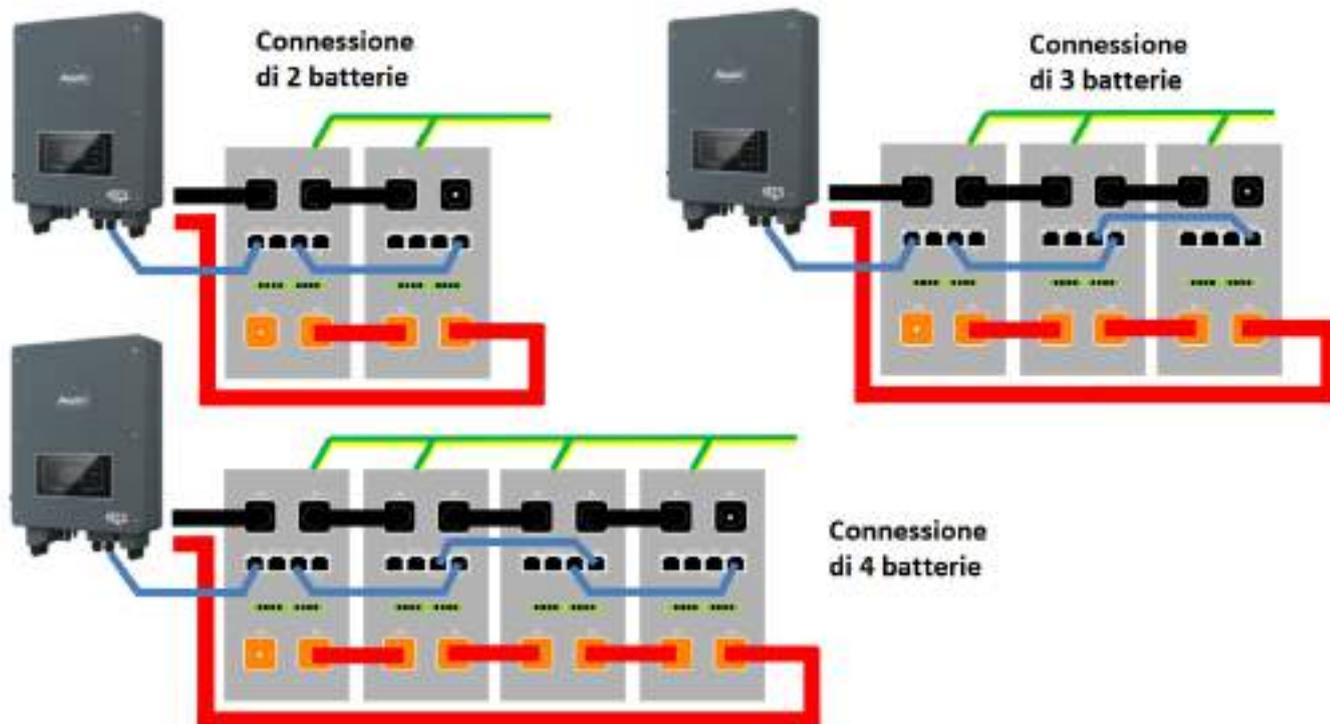
Connessioni di comunicazione fra batterie e inverter (Le batterie sono connesse IN PARALLELO fra loro):
