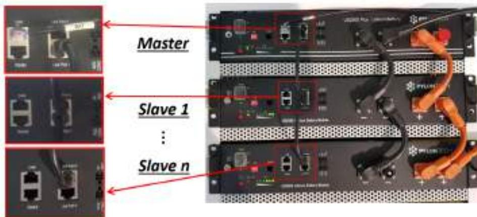
Connessioni di comunicazione fra batterie e inverter:
