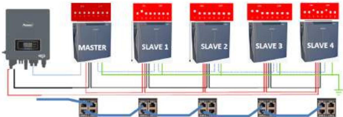
Connessioni di comunicazione fra batterie e inverter:
