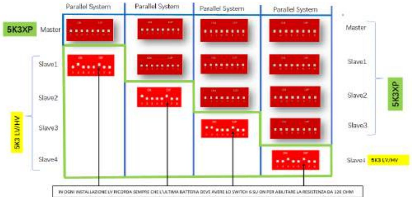
Esempio: connessione di 5 batterie con 5K3XP master 5K3 slave 1-2-3-4.
