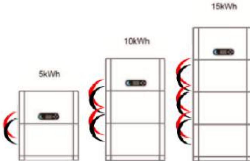
**Installazioni ammesse (4 batterie - necessario cablaggio aggiuntivo)**
