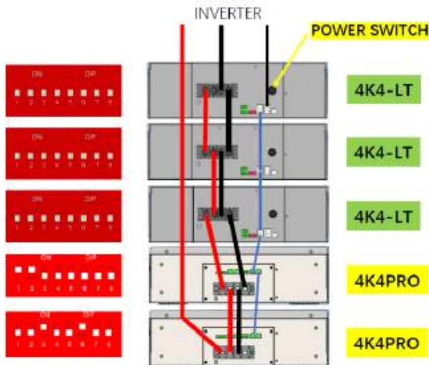
Connessioni di comunicazione fra batterie e inverter:
