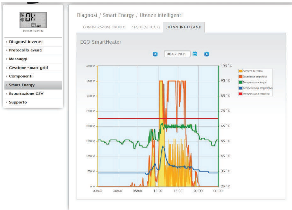
Fig.: Impianto esemplificativo con curva giornaliera EGO-Smartheater e valori visualizzati
