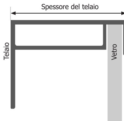
Se lo spessore del telaio è ≤35mm (1.4in), installare con l'etichetta TS4 rivolta verso il modulo fotovoltaico.
