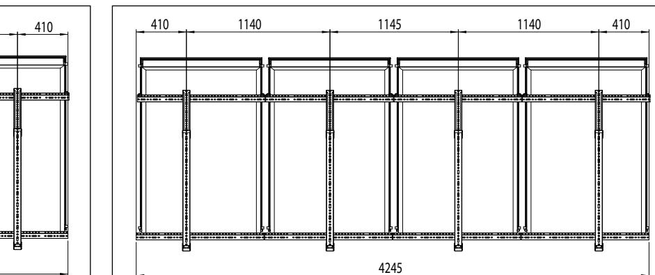
Elke driehoek moet verankerd worden om glijden en omkantelen door de wind te voorkomen, met minstens twee schroeven met een diameter van 12 mm (te kiezen naargelang de situatie): direct op de dakconstructie, met de gaten zodanig gesaald dat er geen water doorheen kan, of op een onderliggende constructie waarin de klant heeft voorzien.
