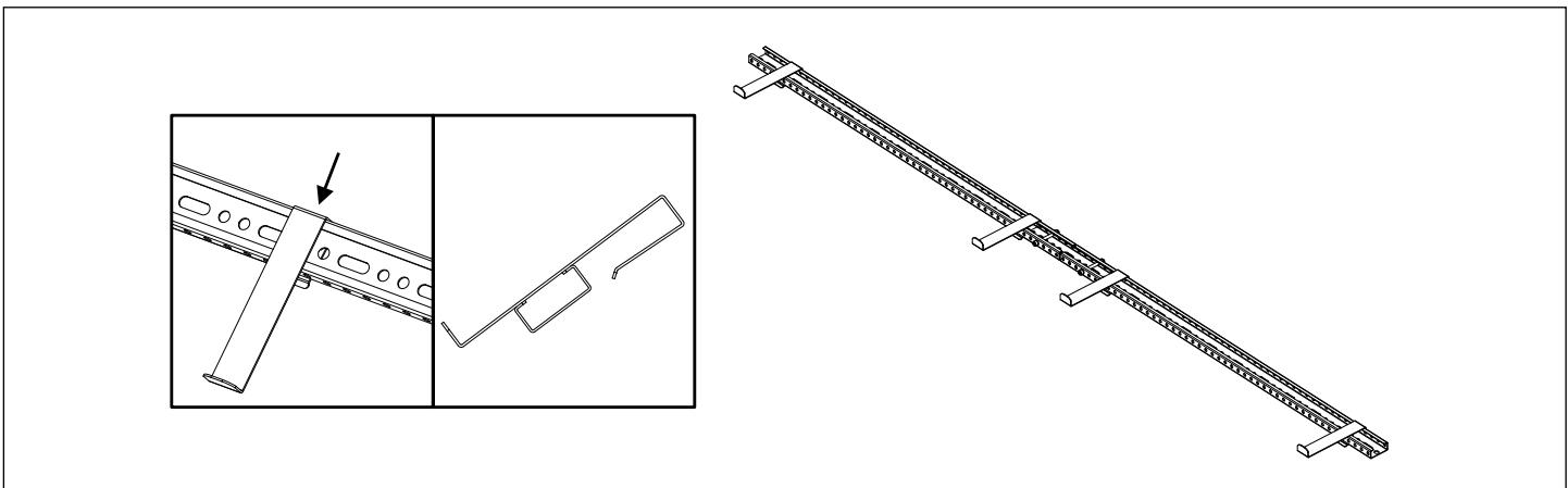
Controleer of de bovenste en onderste staven parallel en in lijn liggen (A) door te meten of de diagonale afstanden hetzelfde zijn (B).
