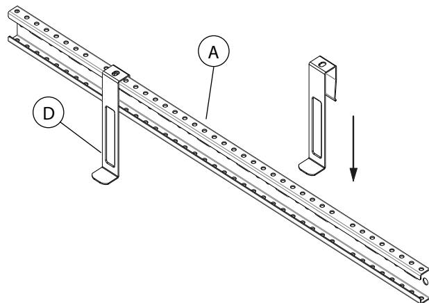
Plaats de antislipbeugels met gelijkmatige afstanden op de horizontale profielen.
