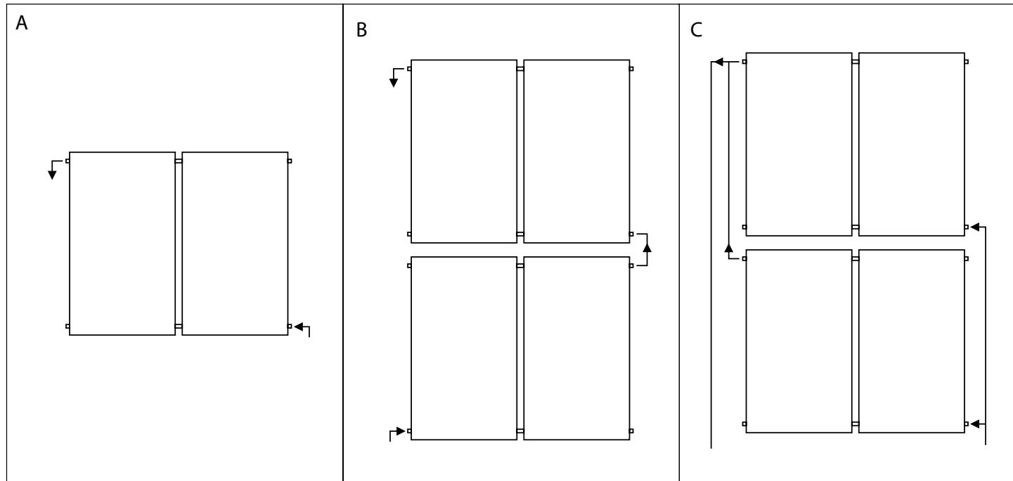
**Afmetingen van de groep collectoren.****Opstelling voor bevestiging op de grond of op een plat dak.**
