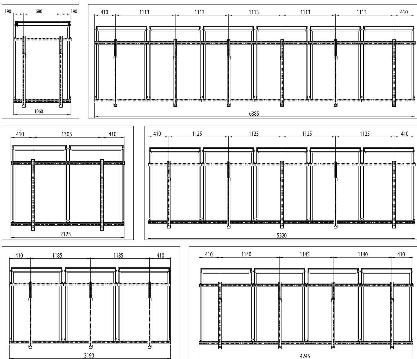
Ogni singolo triangolo deve essere ancorato contro slittamento e capovolgimento, dovuti all'azione del vento, con almeno due viti diametro 12 mm (da scegliere a seconda dei casi): direttamente sulla struttura del tetto, avendo cura poi di sigillare i fori in modo tale da non creare infiltrazioni di acqua o su di una sottocostruzione fatta predisporre dal committente.
