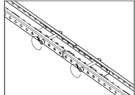
Posicione as estacas antiderrapantes nos perfis horizontais prestando atenção à distância-las de modo uniforme.
