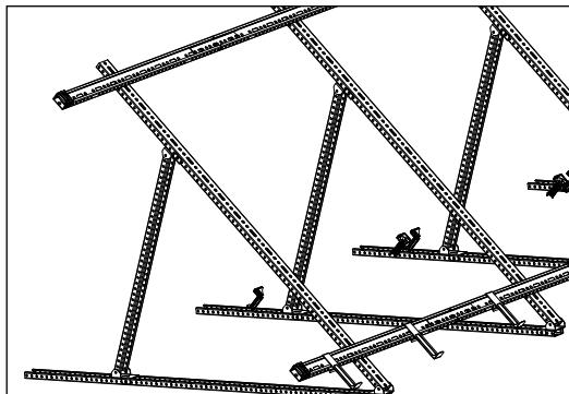
Appoggiare il collettore sulle barre orizzontali e posizionare il profilo del collettore fino a portarlo a toccare con la parte in plastica delle staffe.
