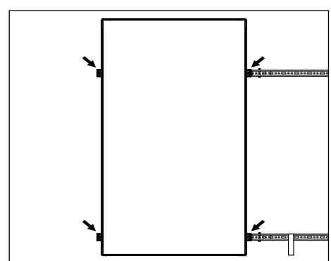
Nel caso si debba montare un altro collettore, inserire una ulteriore staffa di fissaggio su ogni barra orizzontale mettendola a contatto con quella precedentemente installata ed effettuando le stesse operazioni fatte per il primo collettore. Inserire i raccordi idraulici nelle connessioni centrali del collettore già installato ed inserire la clip.
