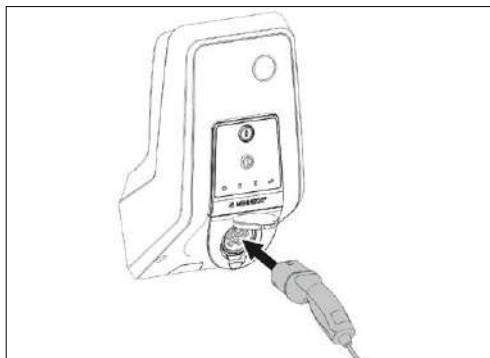
Fig.: 9. Branchement du câble de charge
