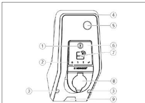
Fig.: 3. Vue de face (exemple : avec prise de charge du type 2 en vue de l'utilisation d'un câble de charge distinct)
