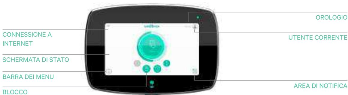
Una volta che Wallbox Commander 2 è pronto e acceso, si utilizza tramite un display touchscreen da 7 pollici o tramite l'app mobile Wallbox.
